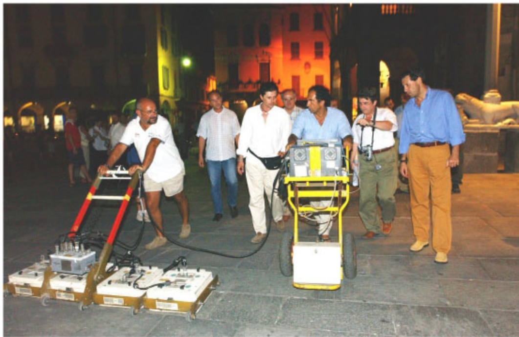
De Palma (secondo da destra) al lavoro con il georadar condotto dai tecnici della Idrogeotech sul sagrato della piazza
